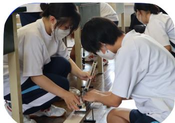
①台車にはたらく斜面方向の力の大きさを、ばねばかりで調べます。台車の位置を変えて調べます。実験の様子を撮影し学習カードに貼り付けます。
