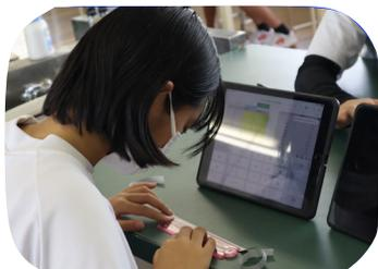
③0.1秒ごとに印をつけて長さを測定します。テープを切り離し方眼紙に並べて貼り付ける操作は、前の実験で全員が体験しています。
