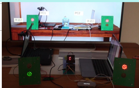
自動車の渋滞状況を画像認識でチェックし、信号の待ち時間を最適化する
